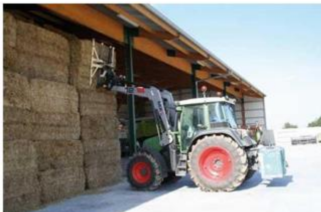
Fig 2 : L'emploi pour manutention d'engin avec de cabine fermée et équipée de système de filtration
