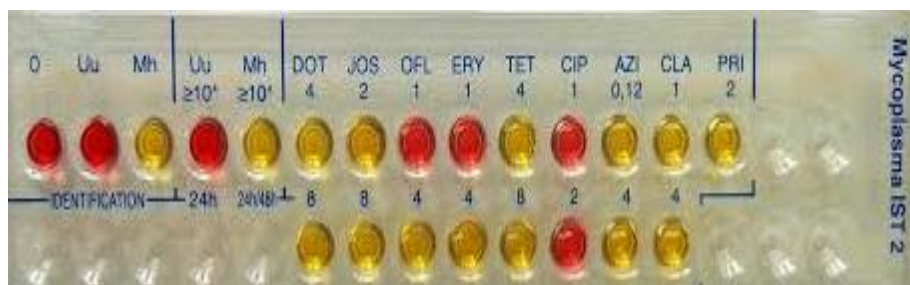
Galleries commercialisées pour l'identification, la quantification et l'étude de la sensibilité aux antibiotiques des mycoplasmes
